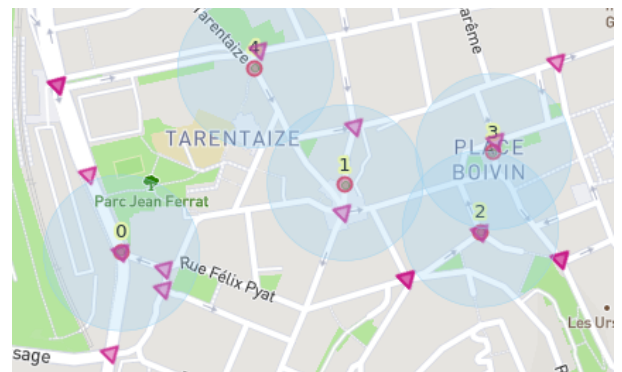
FIGURE 1 – Un exemple de problème AVFAP, avec les sources de demande (triangles) et les taxis (cercles) avec leurs portées de communication respectives (en bleu).
