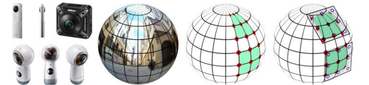
(a) 360° Cameras (b) 360° Image (c) Regular Kernel (d) SphereNet Kernel B. Coors et al, (2018)
