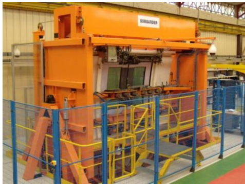
Banc de porte reproduisant toutes les sollicitations subies par les portes
