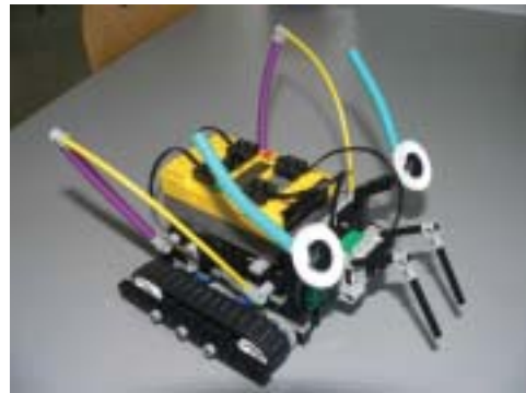
Robot fourmi réalisé à partir d'éléments Lego.
