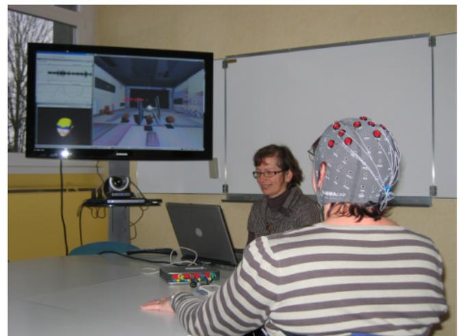
Fig 1 : interface cerveau-ordinateur non invasive. L'activité cérébrale de l'utilisatrice est mesurée par un système EEG (électro-encéphalographie) portable et transformée en commandes. Les traitements sont réalisés dans l'environnement OpenVIBE (<http://openvibe.inria.fr/>)
