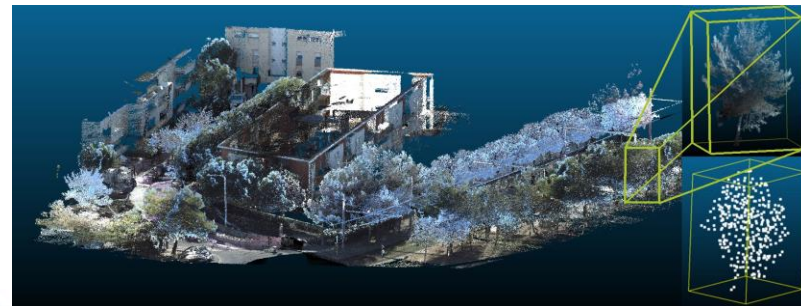
Figure 2 – Vue globale de notre acquisition LiDAR terrestre. On peut y distinguer des arbres, un arrêt de tramway ainsi qu'une petite résidence. A droite, un arbre est isolé puis sous échantillonné en un nuage de 512 points
