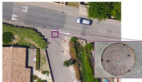
Figure 2.3 – Illustration de détection de plaques d'égouts par vue aérienne
