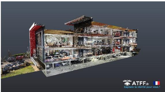
Figure 2.6 – Vue en coupe bâtiment CARL Software (société du groupe Berger-Levrault) en nuage de points, relevé LiDAR
